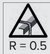
Travaux en hauteur sur plan vertical ou horizontal avec risques de chute verticale par dessus une arête vive. (rayon = 0,5mm) et avec espace disponible sous les pieds de l'utilisateur (voir tirant d'air)
