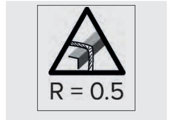
Travaux en hauteur sur plan vertical ou horizontal avec risques de chute verticale par dessus une arête vive. (rayon = 0,5mm) et avec espace disponible sous les pieds de l'utilisateur (voir tirant d'air)
