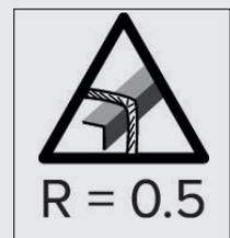
Travaux en hauteur sur plan vertical ou horizontal avec risques de chute verticale par dessus une arête vive. (rayon = 0,5mm) et avec espace disponible sous les pieds de l'utilisateur (voir tirant d'air)
