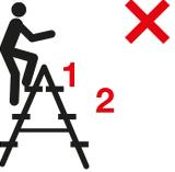
Ne pas se tenir sur les 2 marches/échelons supérieurs d'une échelle double sans plate-forme, ni barre de soutien à hauteur des mains/des genoux
