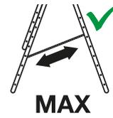
Ouvrir complètement l'échelle avant utilisation (échelles mobiles à plate-forme pliable)
