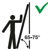
Les échelles d'appui à échelons doivent être utilisées en respectant l'angle approprié
