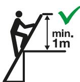
Les échelles servant à accéder à un niveau supérieur, doivent être allongées d'au moins 1 m au-dessus du point à atteindre et doivent être sécurisées, si nécessaire.
