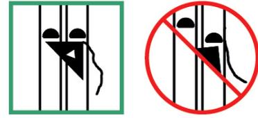
Echelles à coulisse : Vérifier l'enclenchement du mécanisme de verrouillage
