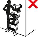
Les échelles doubles ne doivent pas être utilisées comme échelles d'appui
