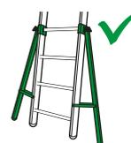
Utiliser l'échelle uniquement si les stabilisateurs sont mis en place.
