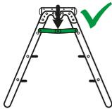
N'utiliser l'échelle mobile que si les dispositifs de sécurité contre l'écartement sont engagés (compas de blocage abaissé)
