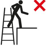
Ne pas descendre d'une échelle double par le côté pour rejoindre une autre surface
