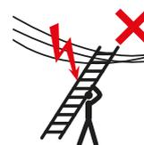
Avertissement - Danger électrique : Identifier tout risque électrique sur le chantier, par exemple des lignes aériennes ou autre équipement électrique exposé, et ne pas utiliser l'échelle en cas de risques électriques.
