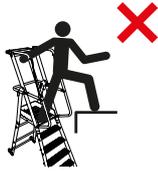
Ne pas descendre d'une échelle mobile avec plate-forme par le côté pour rejoindre une autre surface
