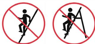
Monter ou descendre à l'échelle simple ou double à marches ou à échelons / à l'escabeau en lui faisant face
