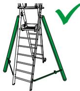
Utiliser uniquement l'échelle mobile avec les stabilisateurs en place
