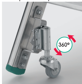
4 roulettes intérieures, pivotantes escamotables à ressort se bloquant sous le poids de l'utilisateur
