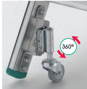
4 roulettes intérieures, pivotantes escamotables à ressort se bloquant sous le poids de l'utilisateur
