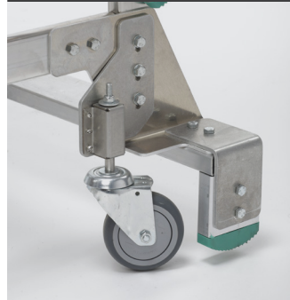
4 roulettes pivotantes escamotables à ressort se bloquant sous le poids de l'utilisateur
