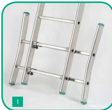
Stabilisateur / Ecarteur Réf. 1801: STABECA 2 échelons (125 mm et 250 mm) 2 possibilités d'utilisation : 1. Stabilisateur pour augmenter la stabilité latérale au sol 2. Ecarteur pour s'éloigner du mur et pouvoir utiliser toute la hauteur de l'échelle
