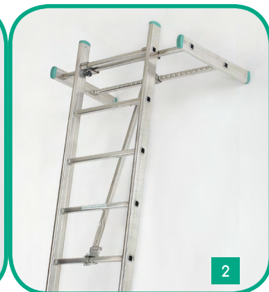
Stabilisateur / Ecarteur Réf. 1801: STABECA 2 échelons (125 mm et 250 mm) 2 possibilités d'utilisation : 1. Stabilisateur pour augmenter la stabilité latérale au sol 2. Ecarteur pour s'éloigner du mur et pouvoir utiliser toute la hauteur de l'échelle
