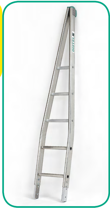
Pointe d'échelle laveur de vitre Réf. 1802 Munie aux extrémités de sabots verts anti-traces. Longueur 1m68 S'adapte uniquement sur l'échelle transformable 3 plans de 2m25 Réf. 1031/225 - pour déploiement totale avec la pointe de 6m93
